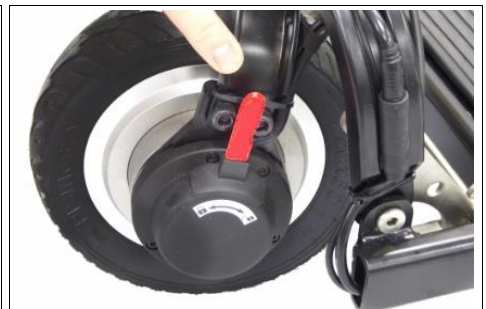
12 Athugaðu hvort segulbremsan sé í LÆSTUR stöðu til að tengja mótörinn.
